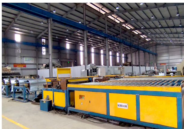
Dây chuyền sản xuất ống gió với máy Auto-line VI Krrass
